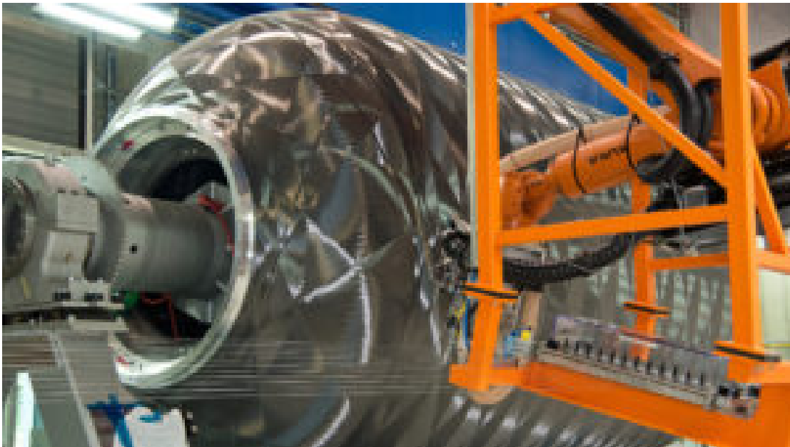
Abbildung 1: Das Boostergehäuse aus Carbonfasern für die Ariane 6 wurde beim DLR Stuttgart und Augsburg in Kooperation mit MT Aerospace entwickelt und gefertigt. Foto: 2015-07-01 (Quelle: DLR (CC-BY 3.0))
